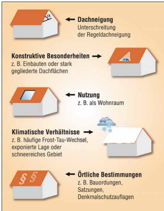
Bild links: Erhöhte Anforderungen an die Regensicherheit Bild rechts: Unterschiede in der Firstausbildung
